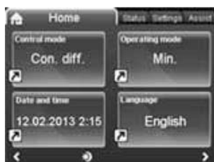
Рис. 12 Пример главного дисплея насоса TPE серии 2000 с улучшенной панелью управления
