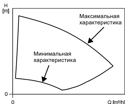
Рис. 56 Мин. и макс. характеристические кривые рабочих точек
