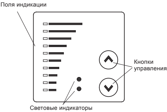
Рис. 53 Рабочая панель для 3-22 кВт, 2-полюсных и 1,5 - 18,5 кВт, 4-полюсных электродвигателей
