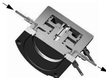
Рис. 33 Очистка предохранительного клапана
