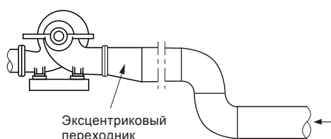
Рис. 31 Правильно смонтированный всасывающий трубопровод
